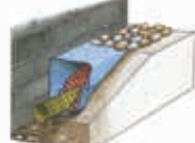
Drenážní obsyp objektu
