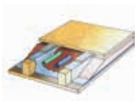
Zásyp trémového stropu s uložením rozvodů sítí
